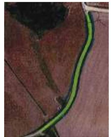
Zone N°2 : Reprise de 150 mètres de voirie comprenant la préparation du support à la niveleuse, la réalisation de poutres de rive, afin de maintenir correctement la voirie sur les 2 côtés, et réalisation d'un bicouche porphyre sur 530 m<sup>2</sup>. **Montant de l'opération : 18 092 € TTC.**
